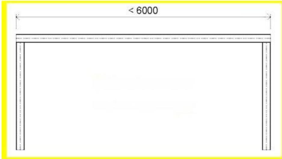
2. Для стабильности конструкции требуются ребра жесткости
