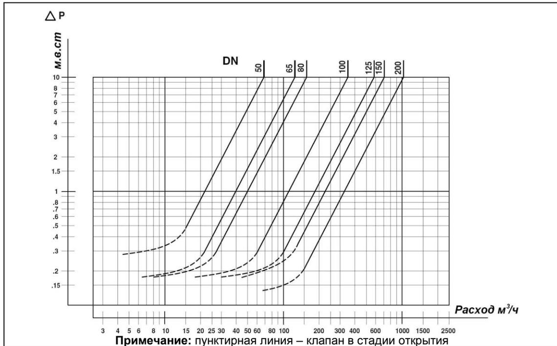
Рис. 1 Диаграмма зависимости потерь давления от расхода рабочей среды клапанов тип NVD 462.
